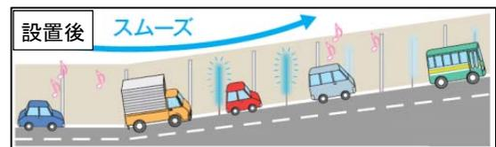
流れる光に誘導されて速度低下の発生を抑制
