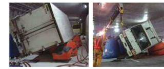
天井の高さの低いトンネル内で、万が一、車両が横転したとき、早期の交通開放のために車両を立て直す設備(エアジャッキ)を配備しています。
