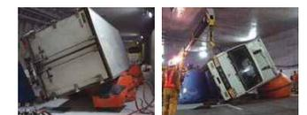
天井の高さの低いトンネル内で、万一、車両が横転したとき、早期の交通開放のために車両を立て直す設備(エアジャッキ)を配備しています。
