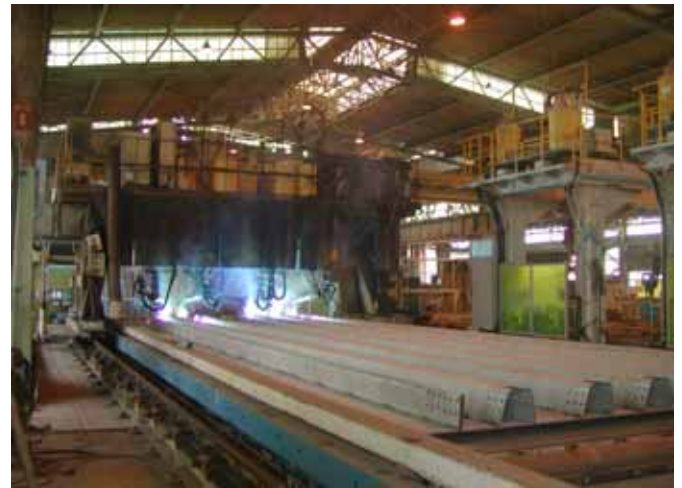
-2 溶接（板と板をつなぐ）
