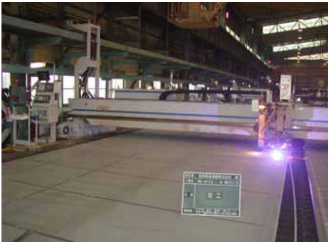
加工（鋼板の切断）
