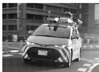
建物や道路の形状などの3次元位置情報を走行しながら高精度で取得できるシステム(MMS)を活用した定期的な詳細点検
