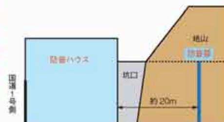
国道1号側坑口。左は平成19年に掘削が完了した生麦方面行きトンネル。12月に設置された「防音ハウス」は幅18.5m×高さ10m×奥行き20m。防音材（グラスウール）の厚さは10cmで、数高品質のものが使われています。
