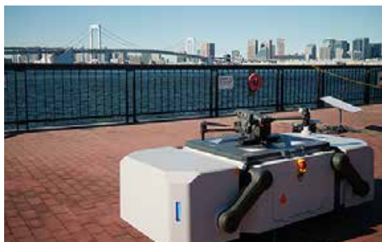
長大橋の自動点検に向けた実証実験の様子
