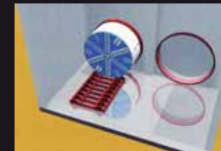
①シールド機引き抜き
