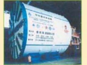
中央環状新設線シールドマシン
